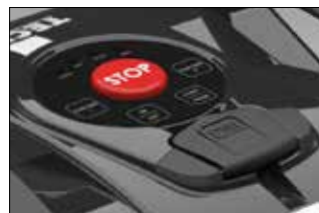
Polecenia z klawiatury i gniazdo ładowania Keypad commands and charging point
